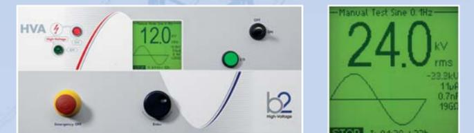
места повреждения. Современная система контроля и управления позволяет пользователю задавать необходимые пороги срабатывания защиты и условия испытания. В случае пробы испытываемой изоляции отображается величина действующего значения пробивного напряжения. Если активирован режим удержания тока пробы (создание условий для определения места повреждения), сопротивление изоляции в месте пробы может быть значительно снижено, что позволит в дальнейшем ускорить определение места повреждения.
