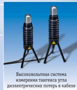
Высоковольтная система измерения тангенса угла диэлектрических потерь в кабеле
