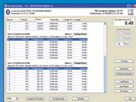
Протокол с результатами проведенной диагностики через Bluetooth интерфейс передается на ПК, где при помощи программного обеспечения для обработки данных "TD Control Centre" пользователь имеет перед собой полную и четкую запись как всей картины измерения в целом, так и отдельных измерений, сделанных в ходе цикла испытаний Тан Дельта.
