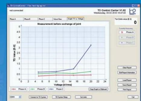
Значения тангенса Дельты отображаются по оси X, в соответствии с приложенным испытательным напряжением (ось Y).
