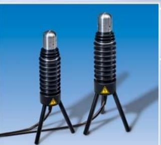
Высоковольтная система измерения тангенса угла диэлектрических потерь в кабеле
