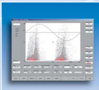
Система диагностики кабельных линий методом измерения частичных разрядов
