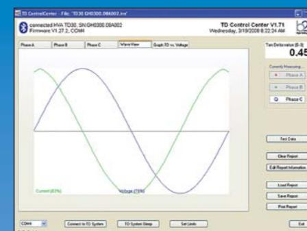
Формы сигнала выходного напряжения и выходного тока одновременно отображаются на экране в режиме реального времени. (режим осциллографа)
