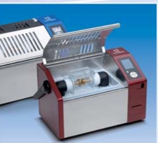
Установка для определения электрической прочности изоляционных масел BA75
